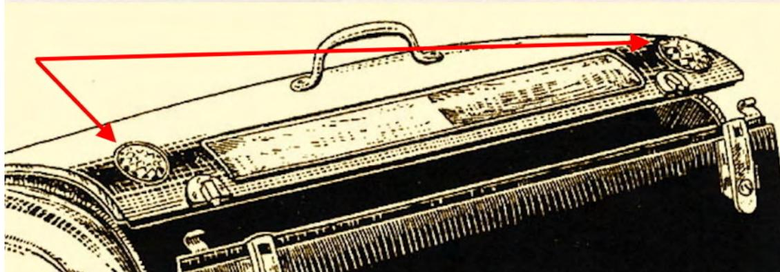
R 124 - Caoutchouc d'étanchéité de feux AR - Réf 291030
