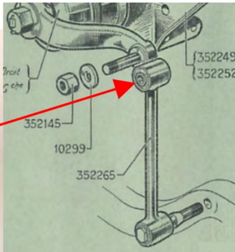
R170 – Arrêtoir d'écrou de fixation sur ressort AR et AV – Ref AC 88767
