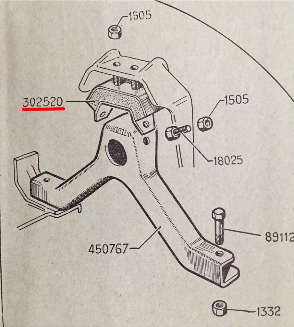
**R 176 - Support isolateur AV de suspension AV du moteur**
